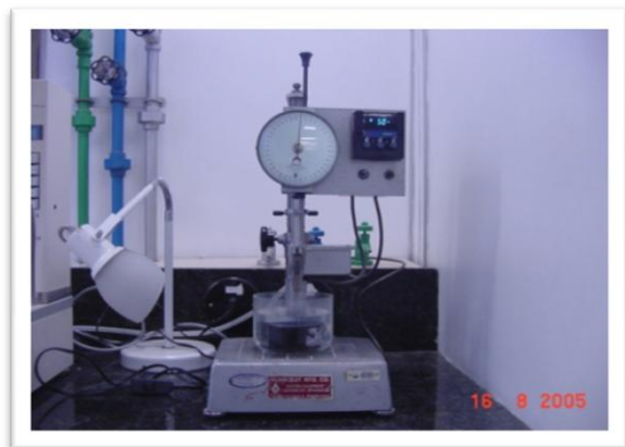
Ensaio de penetração (NBR-6576)
