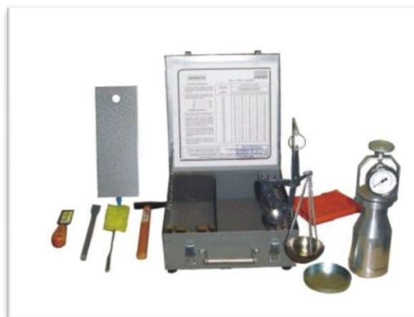
Teor de umidade - Método Speedy (DNER-ME 052/94)
