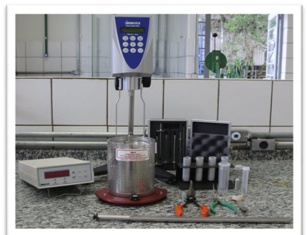
Viscosímetro Brookfield (ASTM D 4402)
