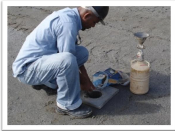
Massa específica aparente "in situ" (DNER-ME036/94)
