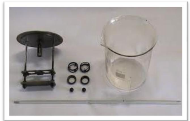
Ponto de amolecimento-anel e bola (NBR 6560)
