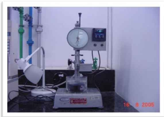
Ensaio de penetração (NBR-6576)
