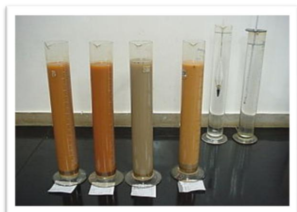
Granulometria por sedimentação (DNER-ME 051/94)
