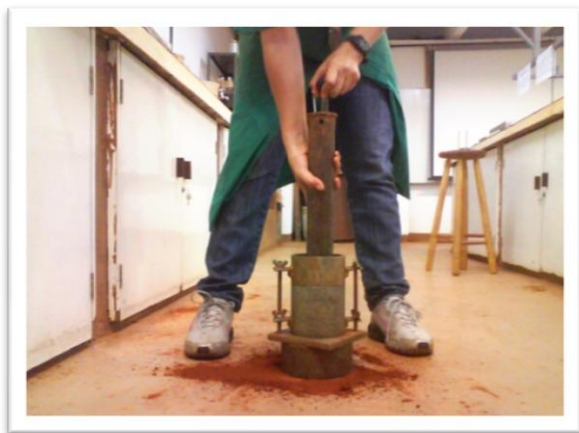
Ensaio de compactação (DNER-ME 129/94)
