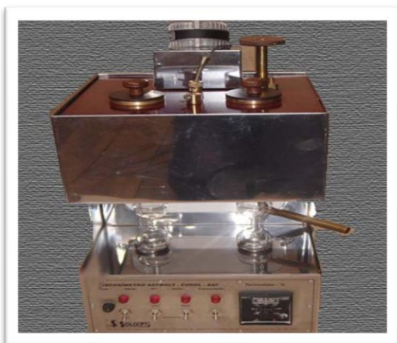
Viscosímetro Saybolt-Furol (NBR 14950)
