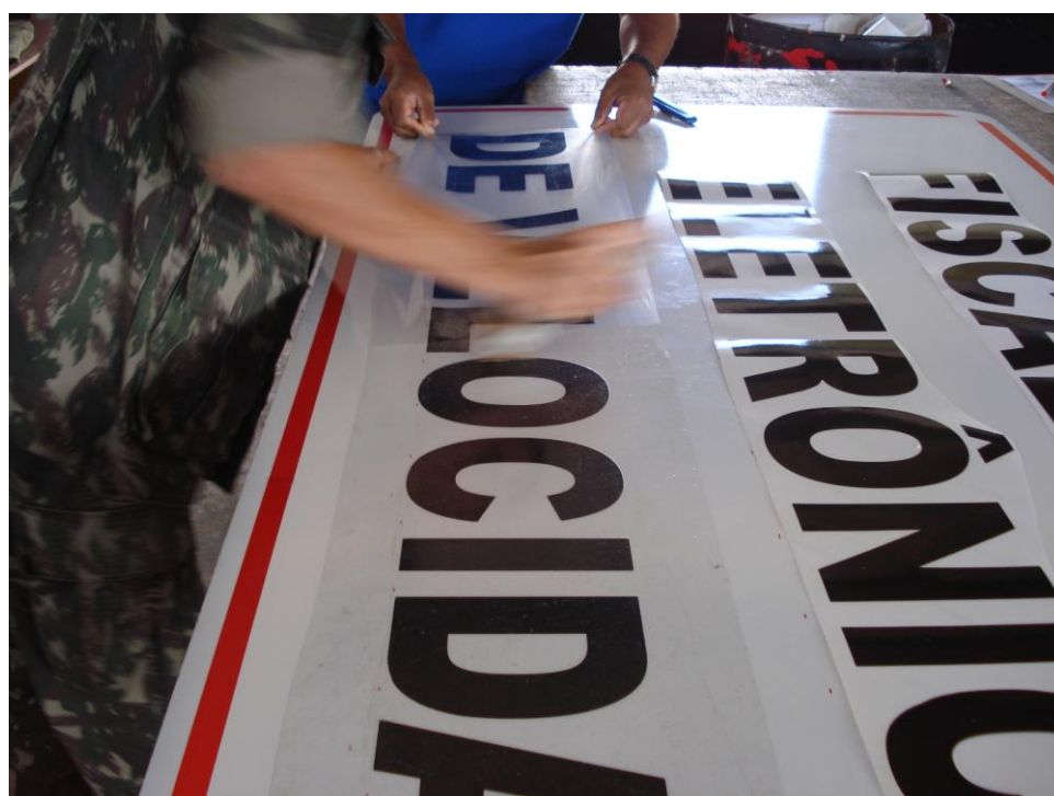
Ilustração 6 - Execução de Placas em Seção Especializada
